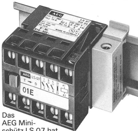
Das AEG Mini-schütz LS 07 hat ein Format, das genau unter die Blindabdeckung im Verteilerkasten passt. Im AC 1-Betrieb schaltet es 16 A und im AC 3-Betrieb 2,2 kW bei 380 V~. Das LS 07 gibt es mit Schraub-, Flachsteck- und Stiftanschlüssen, mit Gleich- und Wechselstromspule – und serienmässig mit Schraub- und Schnappbefestigung.
