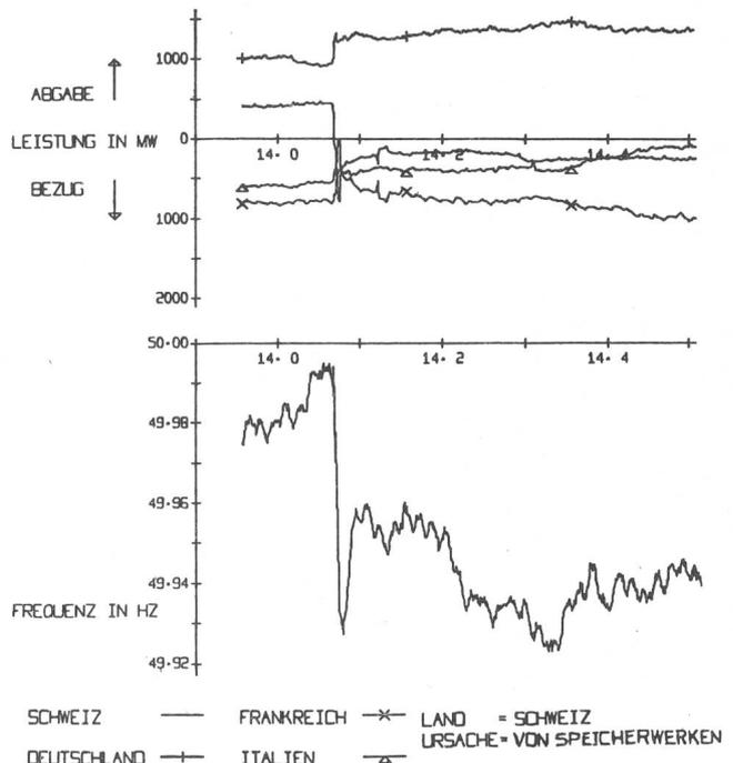
**Fig. 5** Frequenz-Leistungs-Überwachung
