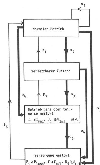
Fig. 1 Mögliche Betriebszustände eines Elektrizitätsversorgungssystems
