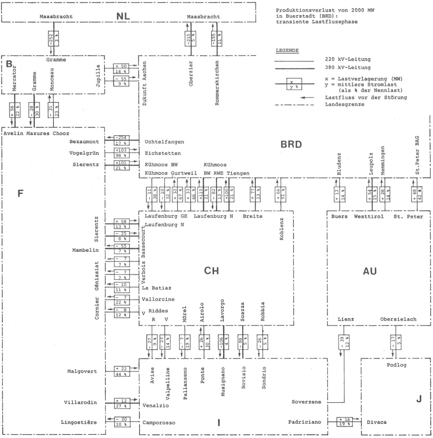
Fig. 9 Lastflussschema der UCPT-Verbundleitungen: transienter Lastfluss nach einer Störung
