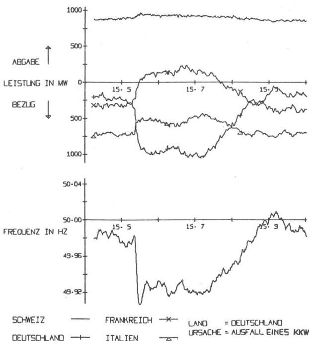
Fig. 2 Frequenz-Leistungs-Überwachung
