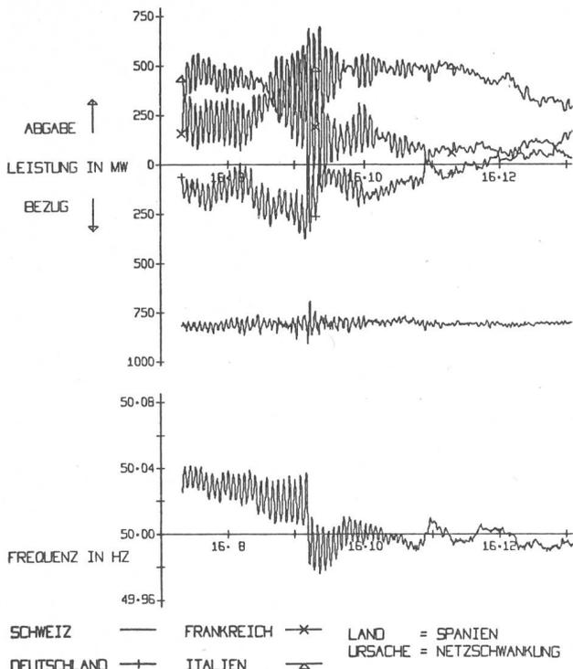
**Fig. 4** Frequenz-Leistungs-Überwachung
