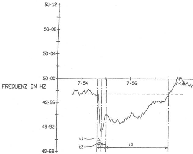
Fig. 7 Frequenzverhalten des UCPTE-Verbundnetzes nach einem Kraftwerksausfall
