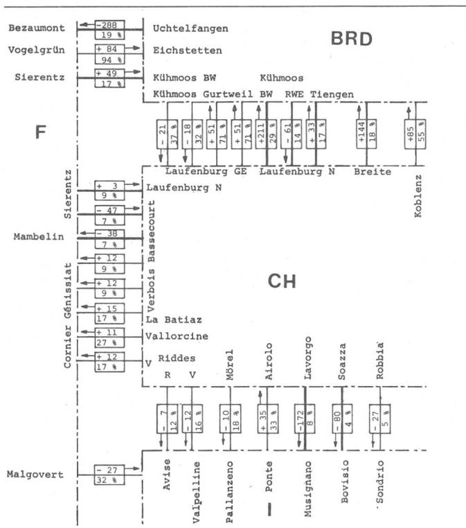
Fig. 10 Lastflusschema (Ausschnitt); stationärer Zustand nach derselben Störung wie Fig. 9
