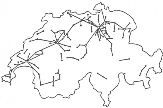
Fig. 11 Digitales Fern- und Bezirksnetz der Schweiz 1980 2 Mbit/s, PCM und Daten
