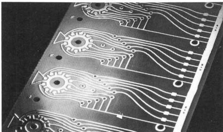
Wesentliche Forderung in diesem System ist Verschleissfestigkeit, die ein konstantes Kontaktverhalten gewährleistet. Diese Forderung erfüllt unsere hochwertige korrosionsbeständige 18-kt-AuCuCd-Legierungsvergoldung GALVATRONIC; sie hat sich seit vielen Jahren in der Elektronik und Elektrotechnik hervorragend bewährt. Die GALVATRONIC-Hartvergoldung zeichnet sich aber auch dank des niederen Goldgehaltes und des geringen spezifischen Gewichtes durch hohe Wirtschaftlichkeit aus.
