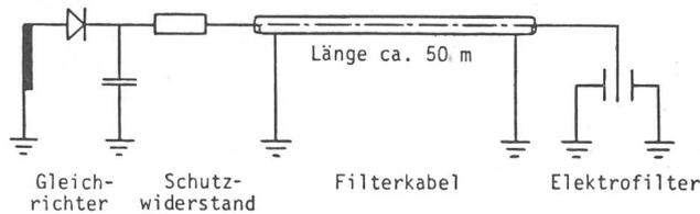
Fig. 2 Schema einer Elektrofilteranlage
