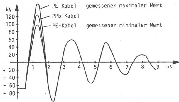
Fig. 5 Gedämpfte Schwingungen gemessen am Eingang des Filterkabels
