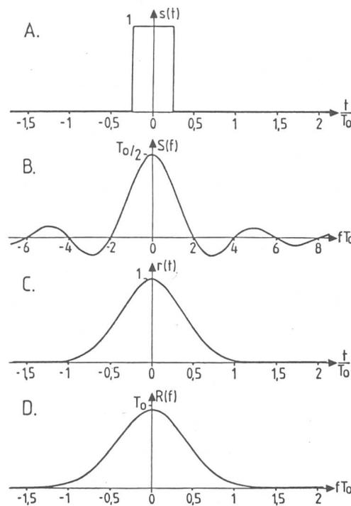
Fig. 3 Darstellung der Impulse im Zeit- und Frequenzbereich
