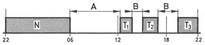
Fig. 12 Blocs de déblocage d'un programme de charge  $T_d = 8 + 6 = 14$  h
