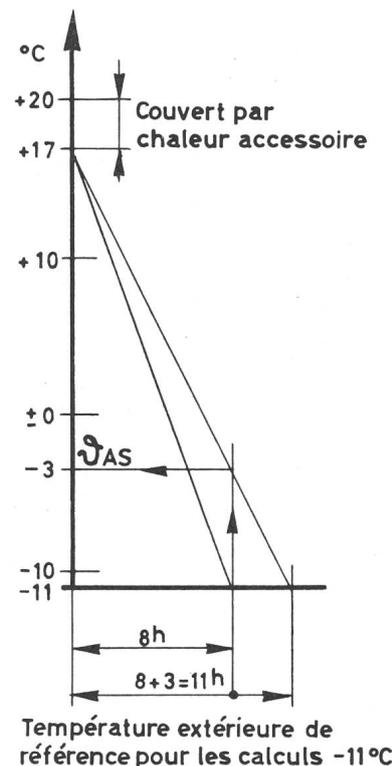
Fig. 10 Détermination de la température limite d'accumulation  $\vartheta_{AS}$
