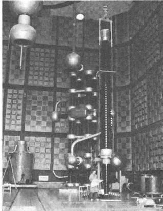
1. Vorfabrizierte Hochspannungsausleitungen aus Transformerboard.
