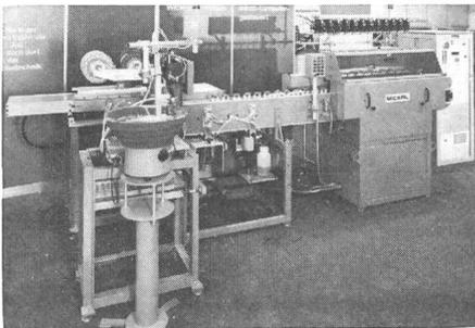
Tauchlöten der Spulenanschlüsse, Zugentlasten der Wicklung durch Nachdrücken der Stifte, elektrische Prüfung der Spule, geordnete Abgabe der Spulen in Paletten zu je 280 Stück. Die Steuerung der gesamten Anlage erfolgt über einen zentralen Mikrocomputer.
