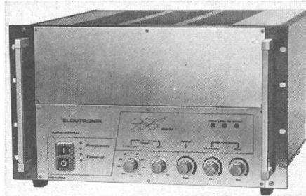
schaltungen existieren ferner eine Signalanpassung, eine Steuerung auf konstante Schnittgeschwindigkeit, eine Frequenz-(Drehzahl-)Anzeige mit Zeigerinstrument sowie eine Bremsenheit für hochdynamische Anwendungen.
