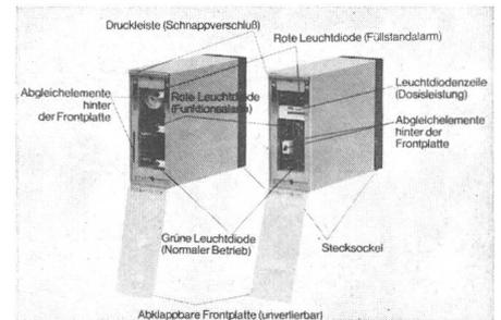
unabgeschirmte Leitungen. Ferner können die Geräte unterscheiden und auch anzeigen, ob ein Füllstand über- bzw. unterschritten ist oder ob eine Störung vorliegt. Sie bieten damit eine Sicherheit gegen Verfälschung des Messergebnisses durch Funktionsfehler.
