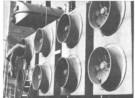
toren mit einem Flügeldurchmesser von 850 mm und einer Fördermenge von 26000 m<sup>3</sup>/h pro Ventilator. Dieser anspruchsvolle Lieferauftrag wurde an die *AWAG A. Widmer AG*, 8036 Zürich, vergeben.
