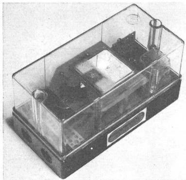
Das Gerät arbeitet nach dem Prinzip der Leistungsmessung. Es wird nach dem Anschliessen geeicht und auf eine normale Betriebsleistung eingestellt. Im Betrieb ermit-
