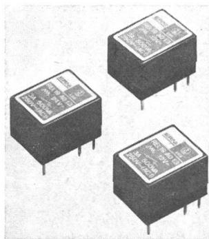
ausgerüstet und für Schaltspannung 250 V AC/30 V DC, Schaltstrom 3 A, Schaltleistung 500 VA/60 W sowie Spulenspannung 6, 9, 12, 24 V DC geeignet. Die Anschlüsse liegen im 1/10"-Rastermass. Weitere Merkmale: hohe Lebensdauer (2×10<sup>7</sup> mechanisch); lötladbeständig. Anwendungsgebiete sind die industrielle Elektronik, Maschinensteuerungen, Alarmgeräte usw.
