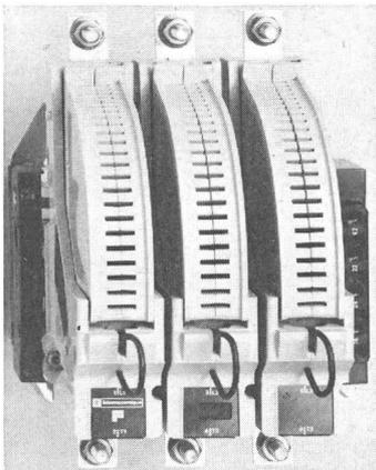
Kondensatorbatterien und Gleichstromkreisen. Es gibt drei Schützetypen von 400 A bis 850 A Nennstrom bzw. 4800 A bis 7000 A Einschaltstrom. Die Ausführung erfolgt in 2, 3 und 4 Polen mit Gleichstromantrieb durch eingebaute Gleichrichter. Die Schütze haben ferner eine Schaltstückabbrand-Anzeige, eine geringe Halteleistungsaufnahme sowie eine Schaltstellungsanzeige, einheitliche Hilfsschalterblöcke, einen mechanischen Verriegelungsbausatz und ein Motor-schutzrelais.
