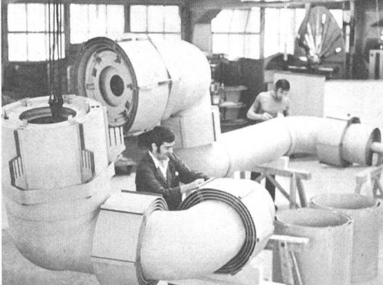
WEIDMANN-Isolationssysteme aus TRANSFORMERBOARD sind TE-frei bis zur Prüfspannung.
