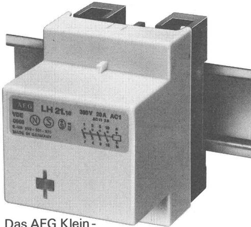
Das AEG Kleinschütz LH 21 ist für 220 V 50 Hz Steuerspannung ausgelegt und hat für die Stromversorgung der Spule einen eingebauten Selen-Gleichrichter. Darum ist es absolut brummfrei und unempfindlich für Spitzenspannungen im Netz.
