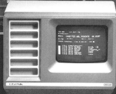
Bedienstation des Gebäudeautomationsystems VISONIK® 4000
