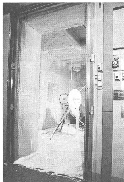
Fig. 2 Vereisungsversuch während der Auftauphase
