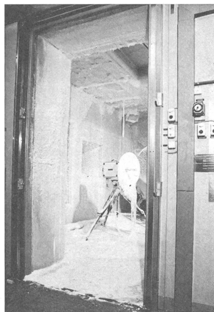
Fig. 2 Vereisungsversuch während der Auftauphase
