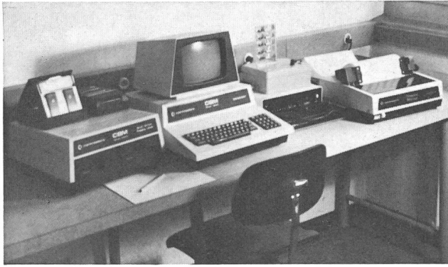
Fig. 4 Computergesteuerter Messplatz für die Typenprüfung von elektronischen Komponenten
