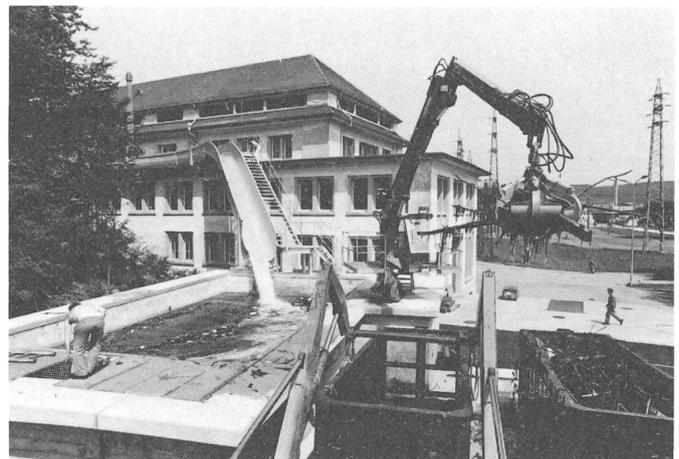
Die Anlage ist nach einer Versuchsperiode kürzlich definitiv in Betrieb genommen worden. Obschon keine ausgeprägten Hochwasser zu verzeichnen waren, sind in dieser Zeit bereits beträchtliche Mengen Geschwemmsel abgeführt worden. Dies obschon in den oberliegenden Anlagen Flumenthal und Bannwil bereits seit längerer Zeit das Treibgut auch herausgenommen wird.
