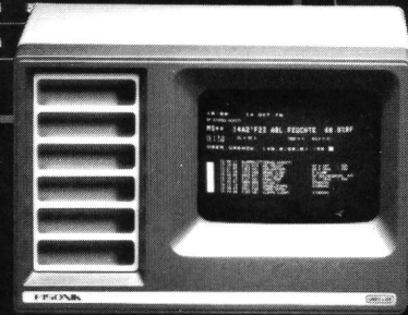
Bedienstation des Gebäudeautomationssystems VISONIK® 4000
