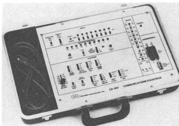
zwei RS 232C/V24 Interfaces und mit einer «Current Loop»-Schnittstelle ausgerüstet. Auf der Empfangsseite bietet ein 1-kByte RAM-Memory die Möglichkeit, einzelne Characters oder verschieden lange Blöcke später abzurufen und zu vergleichen. Die Terminals, ob Bildschirm oder Drucker, können mit dem bekannten ASCII-Character-Set «The quick brown fox...» oder einem vom Kunden spezifizierten Testmuster angesteuert werden. Kurzfristig mögliche Lieferung ist ein weiterer Vorzug dieses Geräts.
