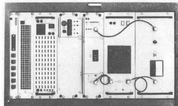
wellenfunkanlagen zur lückenlosen und ungestörten Funkversorgung grosser Gebiete, z.B. für Sicherheitsbehörden, Verkehrsbetriebe und Energieversorgungsunternehmen. Die Geräte sind für Ein- und Vielkanaltechnik ausgerüstet. Dank stabiler Sendeleistung, hochstabilem Oszillator, Modulator mit hoher Hubkonstanz, NF-Laufzeitausgleich, Leitungsentzerrer und automatischem Regelausgleich werden Interferenzstörungen und Modulationsverzerrungen vermieden.
