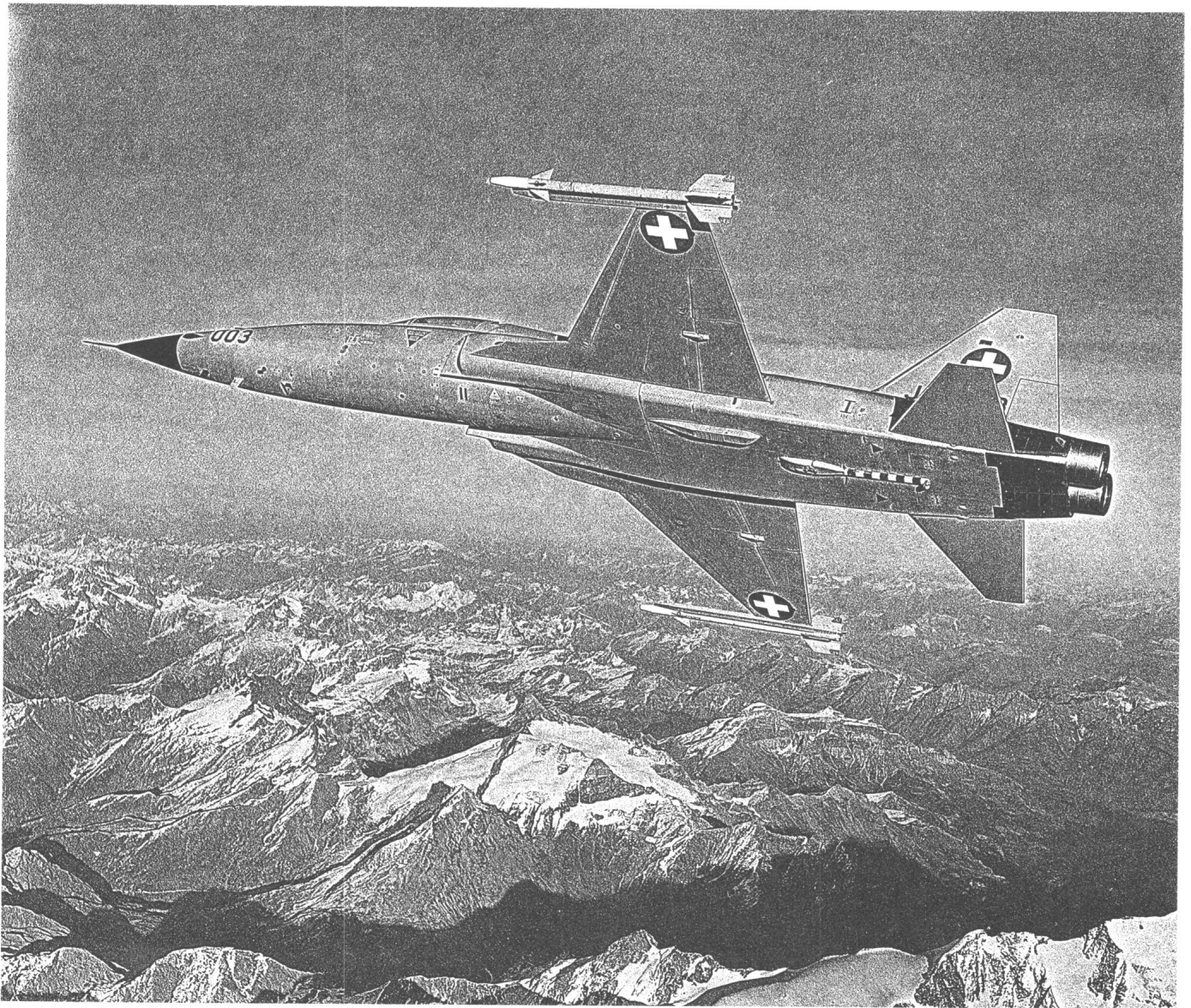
Tiger F-5E, 2 Triebwerke mit total 4550 kg Schub. Spannweite 8 m. Länge 14 m. Leergewicht 4300 kg, max. Abfluggewicht 10 800 kg. Geschwindigkeit 1700 km/Std.
