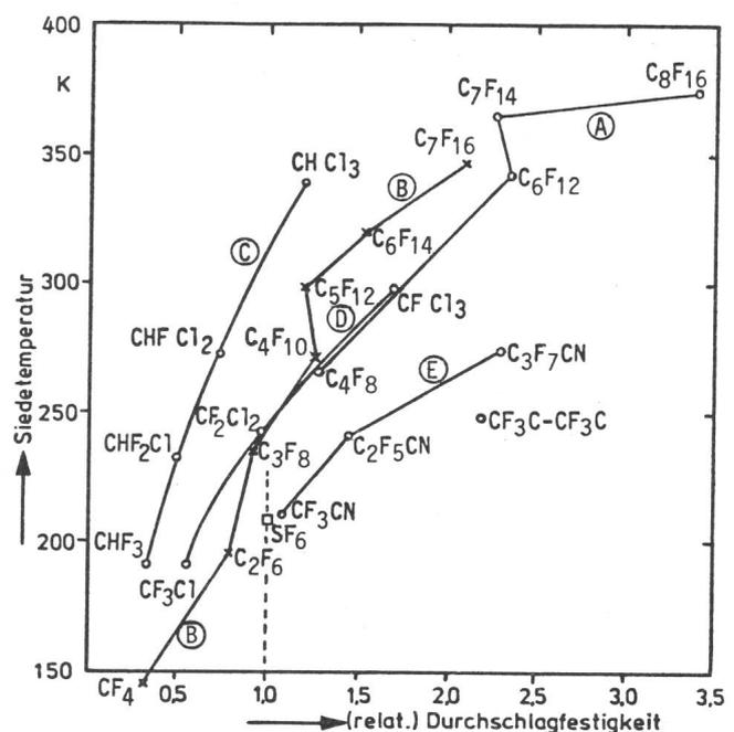
Fig. 2 Verflüssigungstemperatur und relative Durchschlagfestigkeit von Dämpfen (bezogen auf SF<sub>6</sub>) [5]
