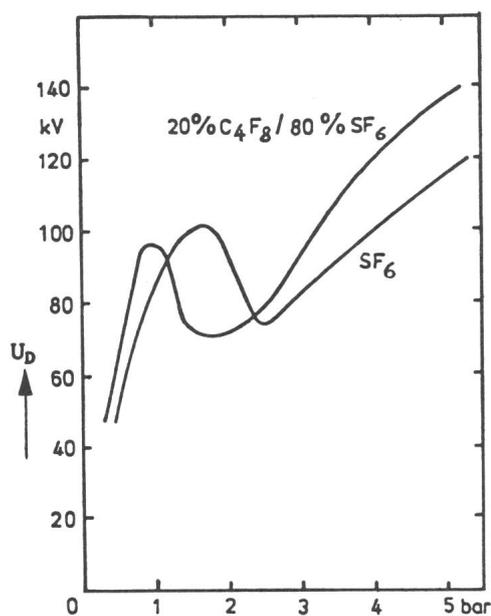
Fig. 6 Durchschlagspannung zwischen positiver Spitze und 1,5 cm entfernter Plattenelektrode in Abhängigkeit vom Druck für Rein-SF<sub>6</sub> und bei 20%iger Zumischung von C<sub>4</sub>F<sub>8</sub> [37]
