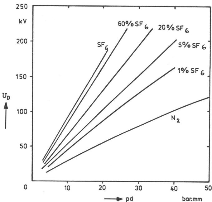
Fig. 4 50-Hz-Durchschlagspannung von N<sub>2</sub> und SF<sub>6</sub>, rein und gemischt (Scheitelwerte) [29]
