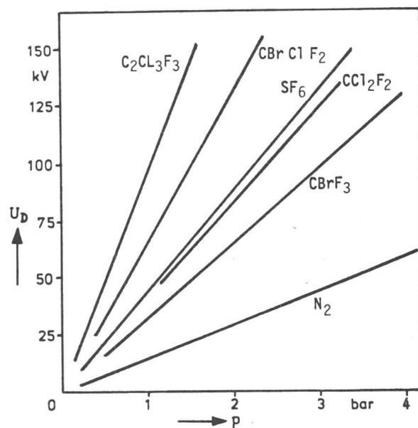
Fig. 1 Durchschlagspannung in Abhängigkeit vom Gasdruck für einige Gase und Dämpfe [15]
