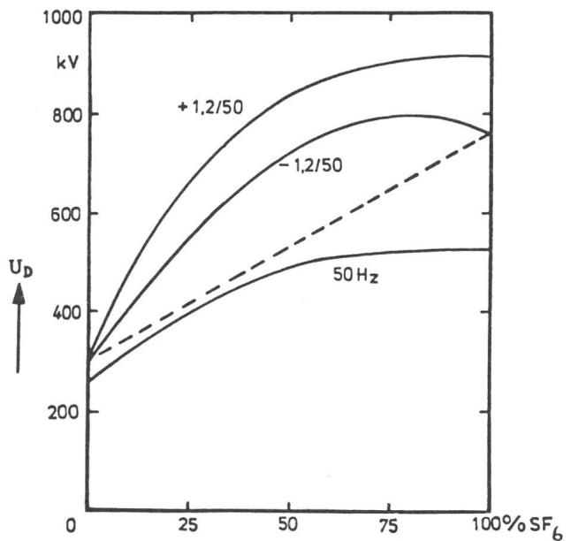
Fig. 5 Durchschlagspannungen bei Blitzstoss und betriebsfrequenter Wechselspannung (Scheitelwerte) bei variablem Mischgrad von N<sub>2</sub> und SF<sub>6</sub>, bei 3,5 bar und 4,0 cm Plattenabstand [35]
