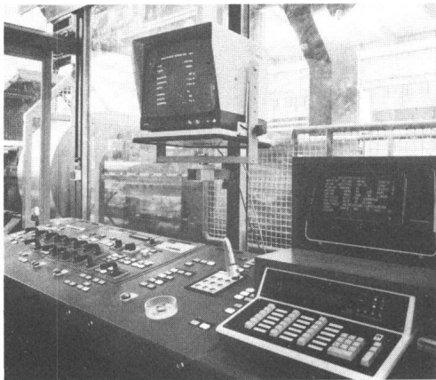
Fig. 5 Steuerstand mit Eingabeterminals und Monitoren einer Dressierstrasse in einem Kaltwalzwerk
