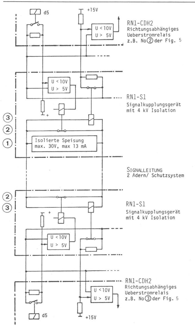
Fig. 6 Prinzip der Signalkupplung mit Gerät RN1-S1
