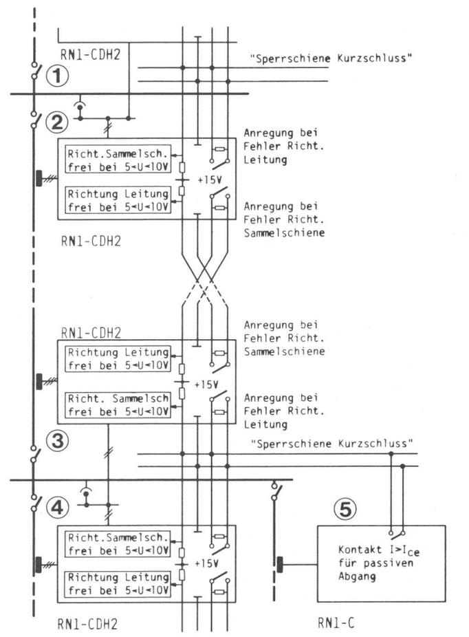
Fig. 5 Prinzip der Signalkupplung des 20-kV-Leitungs- und Sammelschienenschutzes
