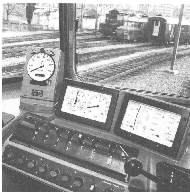
Fig. 3 Führerstand einer Lokomotive, in dem links ein Bahntachograph der Baureihe RT montiert ist
