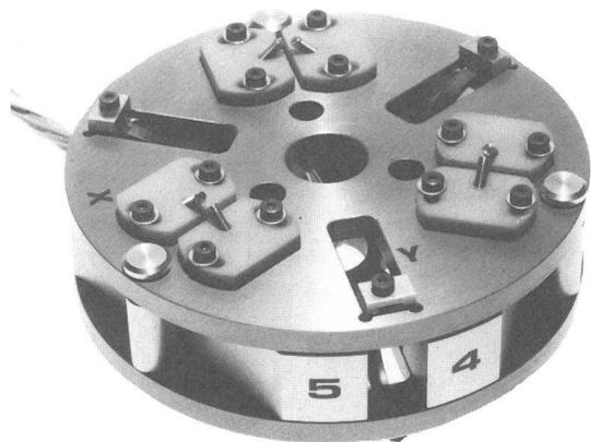
Fig. 1 Capteur de force inductif à 6 composants
