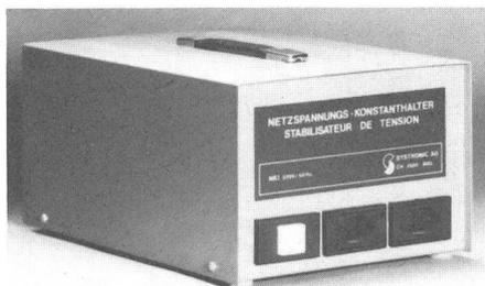
Im weiteren unterdrücken Systronic-Netzspannungskonstanthalter oft auftretende Störspannungen in einem breiten Frequenzbereich. Selbst Kurzunterbrüche im öffentlichen Netz können überbrückt werden. Die galvanische Trennung der Konstantspannung von der Netzspannung lässt die freie Wahl beliebiger Erdungsverhältnisse oder erdfreien Betrieb der Konstantspannungsseite zu. Die Geräte sind verschleiss- und wartungsfrei und können zur Leistungserhöhung ohne Ausserdienststellung
