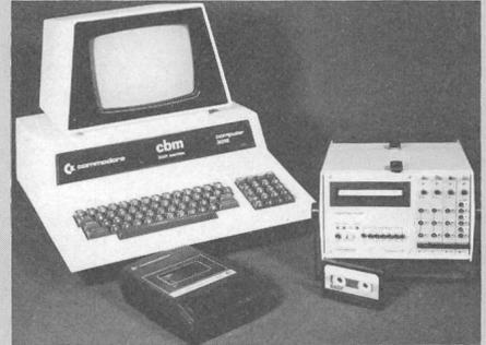
Die Kombination Kassettenregistriergerät Combilog und CBM-Tischrechner ermöglicht, die verschiedensten Messdaten zu erfassen, zu speichern und anschließend die Resultate rasch und gezielt auszuwerten.
