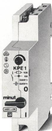
*Treppenlichtautomat mit Digitalelektronik, Baureihe KPE. 100% Einschaltdauer, 50 mA Ruhestrom, für Drei- und/oder Vierdraht-Steigleitungen. Zeitbereiche von 10 s bis 70 min, Dreistellungshandschalter, schmales Normgehäuse von nur 17,5 mm Breite. Einsatz als Zeitrelais.*
