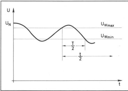
Fig. 2 Délestage d'après l'oscillation de la tension
