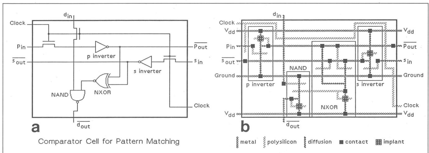
Fig. 2 Beispiel eines Moduls, mit dem VLSI-Editor, dargestellt als Logik-Diagramm (a) und als Stick-Diagramm (b) [6]
