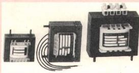
Die Gewindebolzen werden unmittelbar auf den Eisenkern des Transformators geschweisst und dienen als Chassisbefestigung desselben. Die Chassismontage wird dadurch ausserordentlich vereinfacht: Der Transformator positioniert sich von selbst, keine Langlöcher, beansprucht keine zusätzliche Chassisfläche.
