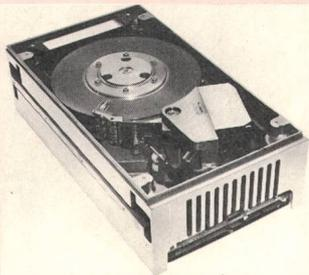
Das Interface ist kompatibel mit dem Lark Drive von Control Data (kombinierte Fest- und Wechsellplatte), der in Ausführung von 8 + 8 MByte und 25 + 25 MByte angeboten wird. Der Windsor 9412 kann, ebenso wie der Lark 9455/9457, mit einem Adapter an das Standard Storage Module Drive (SMD) Interface angeschlossen werden. Die MTBF beträgt 10 000 h.
