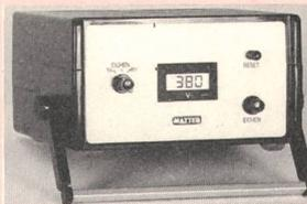
Kurz die wichtigsten Daten: Eingangsspannung: 180...420 V, 45...65 Hz; Spannungsabsenkungsbereich: 0...199,9 V; Genauigkeit: 0,5%; LCD-Anzeige 12,5 mm hoch. Das Messgerät ist in einem schlagfesten Kunststoffgehäuse mit Tragriff aufgebaut und hat ein fest verbundenes Zuleitungskabel mit doppelt isolierten Krokodil-Klemmen.
