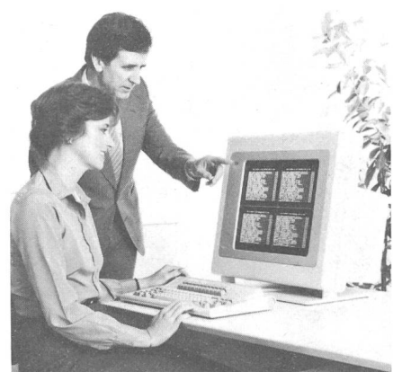
Fig. 1 Bildschirm mit Plasmaleuchtplatte
