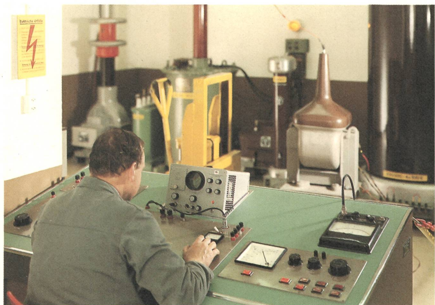
Vérification d'un transformateur de mesure
