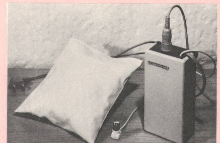
Hörkissen-Empfangsanlage (Velectra AG)
