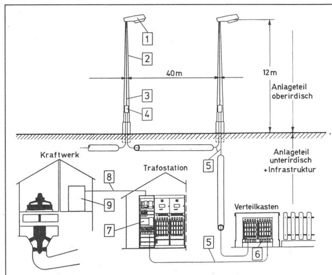
Fig. 5 Anlage-Komponenten
