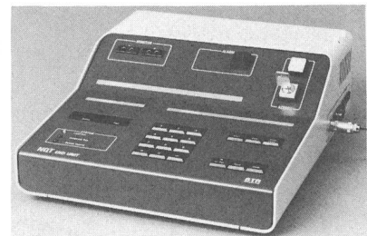
Fig. 6 Einfacher Testanrufbeantworter NQTE für die Verwendung in kleinen Ortszentralen
