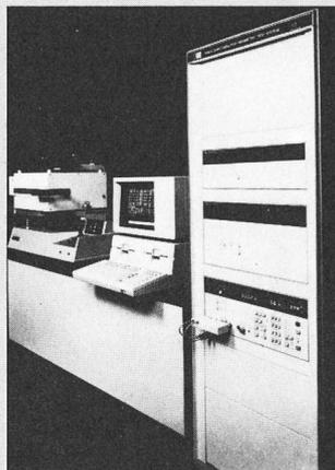
wendung bei der Herstellung und Prüfung von Halbleiter-Wafern. Die parametrischen Testdaten können z.B. zu einem Waferplan oder einer Kontrolltabelle aufbereitet werden. Die Testinformationen können bei Rückmeldung die Waferprozesse stabilisieren und die IC-Ausbeute und -Qualität erhöhen. Die Testanlage besteht aus folgenden Baugruppen:
