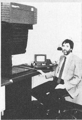
Die Bedienung erfolgt über ein Bildschirmterminal, das alle Arbeitsschritte in einer Bedienungsanleitung im Klartext angibt. Alle Daten werden zentral gespeichert, stehen zur späteren Wiederholung zur Verfügung und können archiviert werden. Im Color-Fachlabor ermöglicht das standardisierte Verfahren einen hohen Qualitätsstandard für Colordu-
