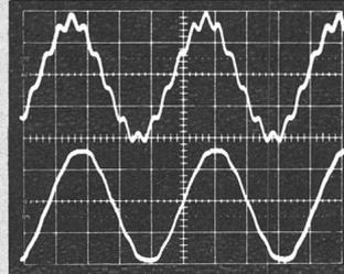
Waschmaschinen usw. verwenden die Elektrizitätswerke Tonfrequenzsignale, welche der Netzspannung überlagert werden. Diese Netzkommandosignale führen häufig zu Störungen bei anderen empfindlichen Verbrauchern, die ebenfalls dem öffentlichen Netz angeschlossen sind. Der einwandfreie Betrieb solcher Verbraucher ist nur durch eine «saubere» Stromversorgung, resp. durch das Vorschalten eines
