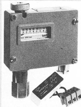
Innerhalb von -0,9...400 bar stehen 20 Messbereiche zur Verfügung. Anstelle des mechanischen Mikroschalters kommt ein induktiver Näherungsschalter zur Anwendung, welcher auch in feuchter Umgebung einwandfrei arbeitet, da er vollständig gekapselt ist. Alle Druckschalter entsprechen der Schutzart IP 65.
