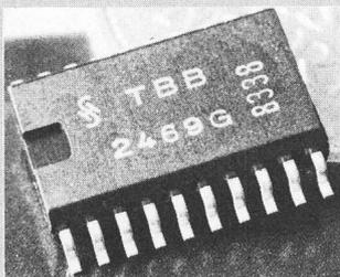
Im TBB 2469 gelangt das Eingangssignal über einen HF-Verstärker an einen quartzesteuerten Mischer. Nach externer Selektion folgt ein Begrenzerverstärker und anschließend ein Koinzidenzdemulator. Die NF wird einem Tiefpass zugeführt, dem sich ein doppelter NF-Verstärker anschliesst: Die Verstärkung und der Frequenzgang des ersten Verstärkers können extern eingestellt werden; dadurch lassen sich unvermeidliche Streuungen der Serienproduktion ausgleichen. Der zwei-
