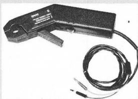
Wird die Stromzange an ein Oszilloskop angeschlossen, ist die Kurvenform des Stromes ersichtlich. Einzige Begrenzung ist die bei etwa 5 kHz liegende Bandbreite der Stromzange.
