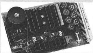
Dank dem Einsatz moderner Schaltungstechnik mit Leistung-FET liegt der Wirkungsgrad des Reglers je nach Ausgangsspannung bei 75...95%. Die geringe Wärmeentwicklung steigert die Zuverlässigkeit der Schaltung. Die Typen DWV-10 und DWV-11 liefern im ganzen
