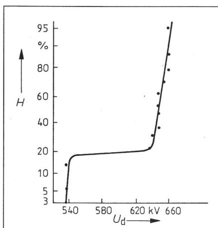
Fig. 6 Summenhäufigkeit  $H$  der Durchschlagspannung  $U_d$  der negativen 100-cm-Stab-Stab-Funkenstrecke
