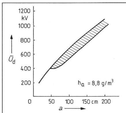
Fig. 5 Durchschlagspannung  $\bar{U}_d$  der Stab-Stab-Funkenstrecke in Abhängigkeit vom Abstand  $a$  bei beiden Polaritäten der Gleichspannung
