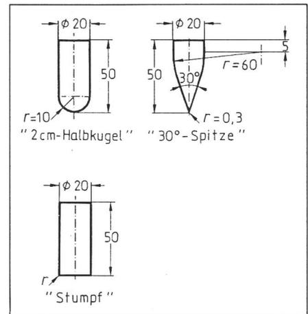
Fig. 4 Massskizze der verschiedenen Abschlusselectroden
