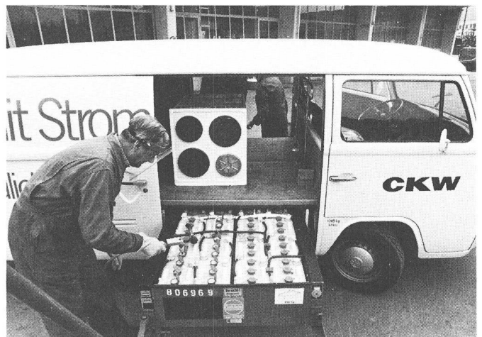
Fig. 2 VW-Elektrotransporter der CKW mit ausfah- render Batterie
