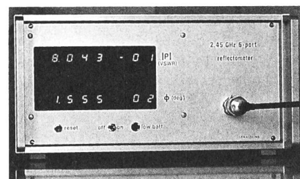
Fig. 5 Le réflectomètre à hexaporte complet, y compris la source de signal à 2450 MHz (MESFET) et l'alimentation par batteries
