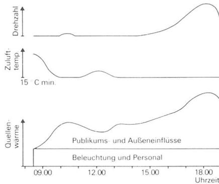
Fig. 8 Einsatz der Drehzahlregelung während eines Tages
