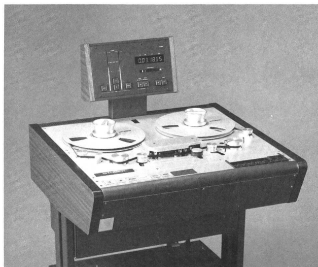
Fig. 7 Prototyp des DASH-Recorders D 820 (19 cm/s, 2 Kanäle)
