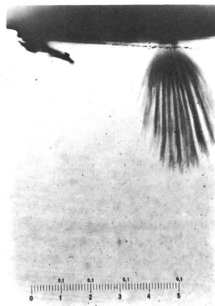
49031 Fig. 7 Wasserbäumchen, ausgehend von einer glatten Stelle der Leitschicht
