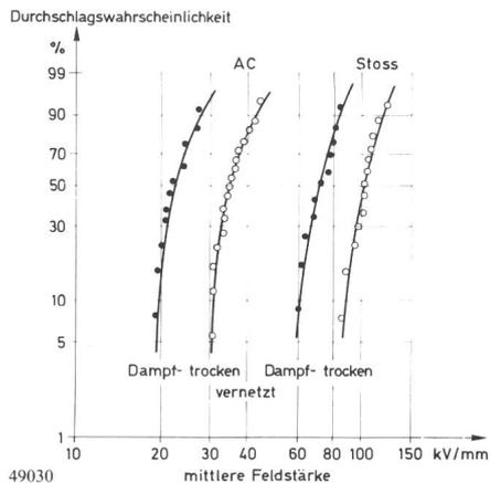
Fig. 1 Durchschlagsfestigkeit unterschiedlich vernetzter 66-kV-VPE-Kabel (nach Nagasaki)
