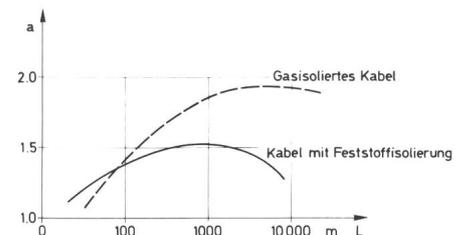
Fig. 8 Einfluss der Länge eines feststoff- bzw. gasisolierten Kabels auf die Blitzüberspannung (nach Bernard)
