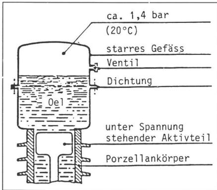
Fig. 1 Dichtungssystem eines Wandlers mit Gaskissen und konstantem Volumen
