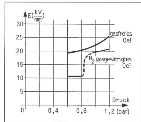
Fig. 3 Teilentladungseinsatz der elektrischen Feldstärke
