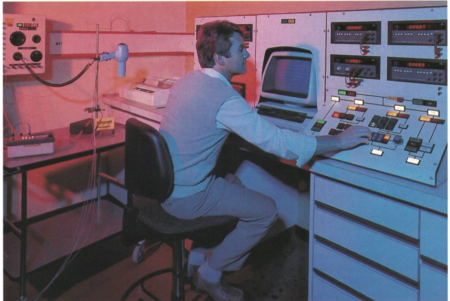
Computergesteuerter Dreiphasen-Messplatz für Strom, Spannung, Leistung, Widerstand und Temperatur in der Materialprüfanstalt; Eigenbau des SEV.
