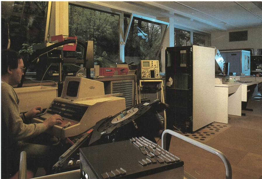
La zone de test du CSEE. Au centre la nouvelle Sentry 10; au premier plan un collaborateur travaillant au terminal de l'Accutest 7700, équipement de test pour mémoires.
