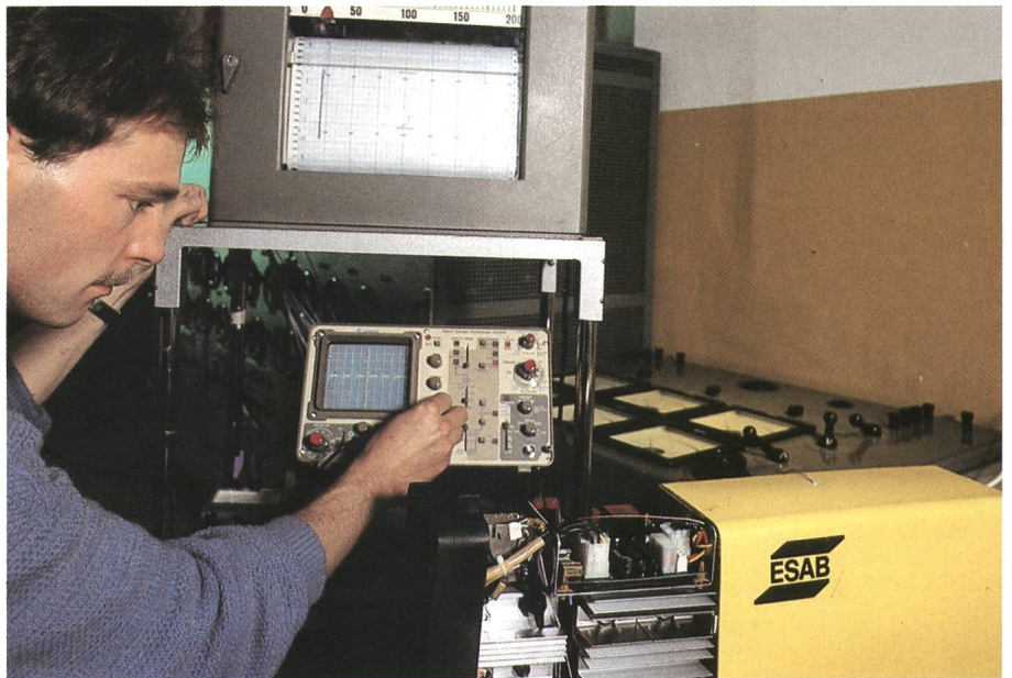
Préparation de l'essai de durée d'un appareil à souder à la Station d'essais des matériaux.
