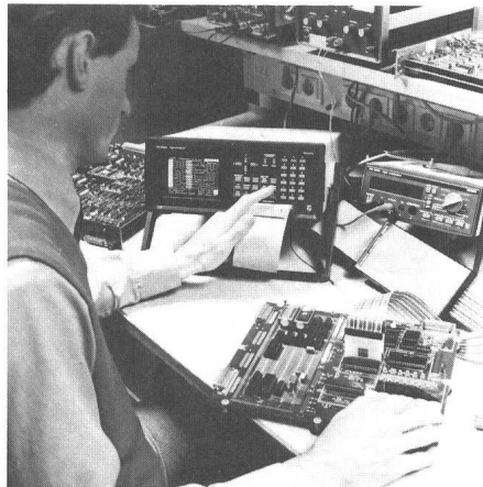
Fig. 4 Logikanalysatoren gestatten das gleichzeitige Erfassen von Datenströmen bei einer Vielzahl von Knotenpunkten
