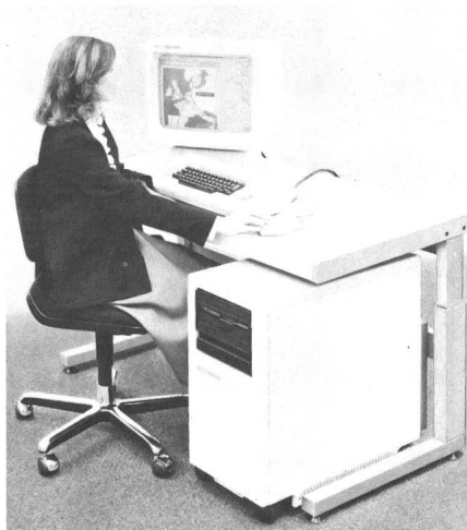
Fig. 1 Multifunktionale Arbeitsstation Xerox 8010 Auffällig sind der grosse Bildschirm und die Maus.
