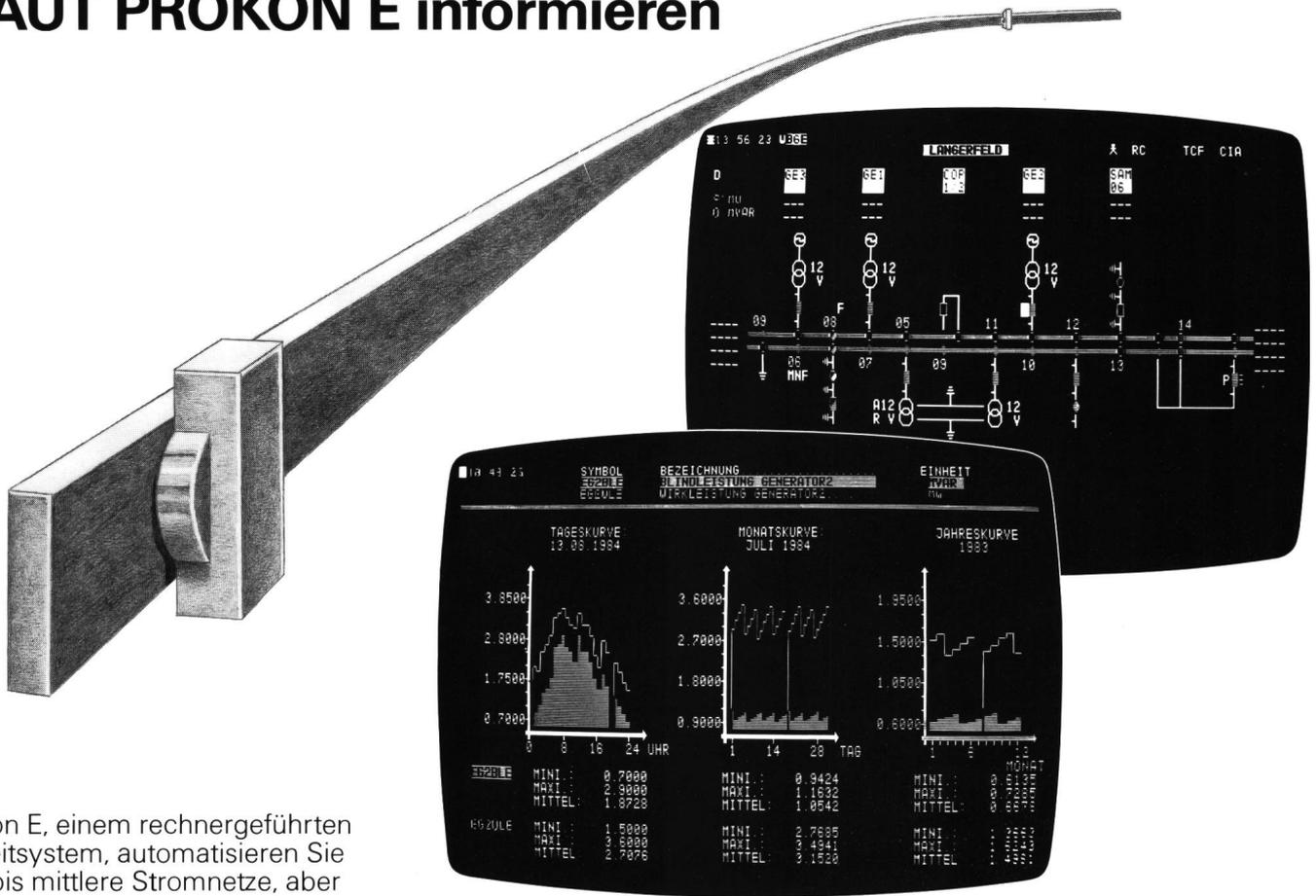
Mit Prokon E, einem rechnergeführten Prozessleitsystem, automatisieren Sie kleinere bis mittlere Stromnetze, aber auch Gas-, Wasser- und Fernwärmenetze.
