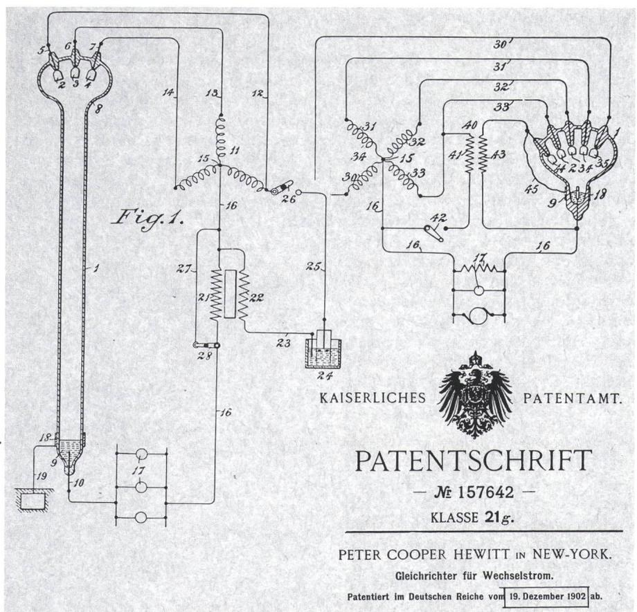
Fig. 5 P. Cooper Hewitt patentierte im Jahre 1902 den ersten Quecksilberdampf-Gleichrichter
