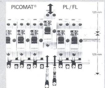
in Verteilern mit 125 mm Tragschienenabstand. Die maximalen Anschlussquerschnitte betragen, wie bei allen Sammelschienenbugeln, bei Rundkopper bis 16 mm<sup>2</sup> und bei Flachschienen bis 4x10 mm.
