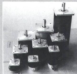
Die Lebensdauer der Moto- ren beträgt über 40 000 Betriebs- stunden, welche, weil Kohlebürsten und andere Ver- schleisssteile fehlen, nur von der Lagerbelastung und den allge- meinen Betriebsbedingungen abhängig ist. Die mit Keilnuten (DIN 8685) versehenen An- triebswellen-Durchmesser be- tragen, je nach Typ, 10 bis 16 mm bzw. ¼ bis ⅜ Zoll.
