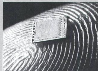
Der Megapixel-Sensor wurde vom Kodak-Forschungslabor in Rochester entwickelt. Die Erhöhung der Bildpunktzahl wurde möglich durch die Ver- ringerung der Abstände zwi- schen den einzelnen Bildemp- fangs-Elementen und durch deren spezielle Anordnung, die eine Reduktion der für die Bild- auswertung benötigten Transi- storschaltungen ermöglicht. Für eine geeignete Auswertung der Bildinformation durch elektronische Rechner ist die quadratische Form der einzel- nen Pixels gewählt worden.
