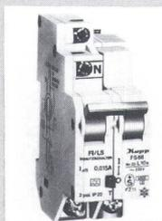
ne Merkmale: problemlose Schnellmontage auf Normschiene, Eingangsklemme fur Drahte von 1-16 mm<sup>2</sup>, mit gleichzeitigem Sammelschienen-Anschluss und vor allem nur 35 mm breit. Die Klemmschrauben sind Kombischlitzschrauben. Das Gehause ist bruchfest, der Kipphebel fur Ein/Aus plombierbar.
