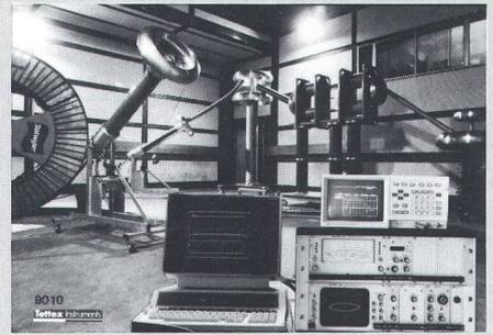
Bei der Herstellung kunststoffisolierter Hochspannungskabel können Fehler auftreten, die unter Spannungsbeanspruchung zu örtlich auftretenden Teilentladungen im Kabel führen. Das Fehlerortungssystem 9010 von Tettex erlaubt die genaue Ortung auch kleinster Teilentladungen. Bei angelegter TE-freier Prüfspannung werden durch die Entladung im Kabel Stromimpulse erzeugt. Diese werden über den angeschlossenen Kopplungskondensator ausgekoppelt und über die Messimpedanz dem Teilentladungs-
