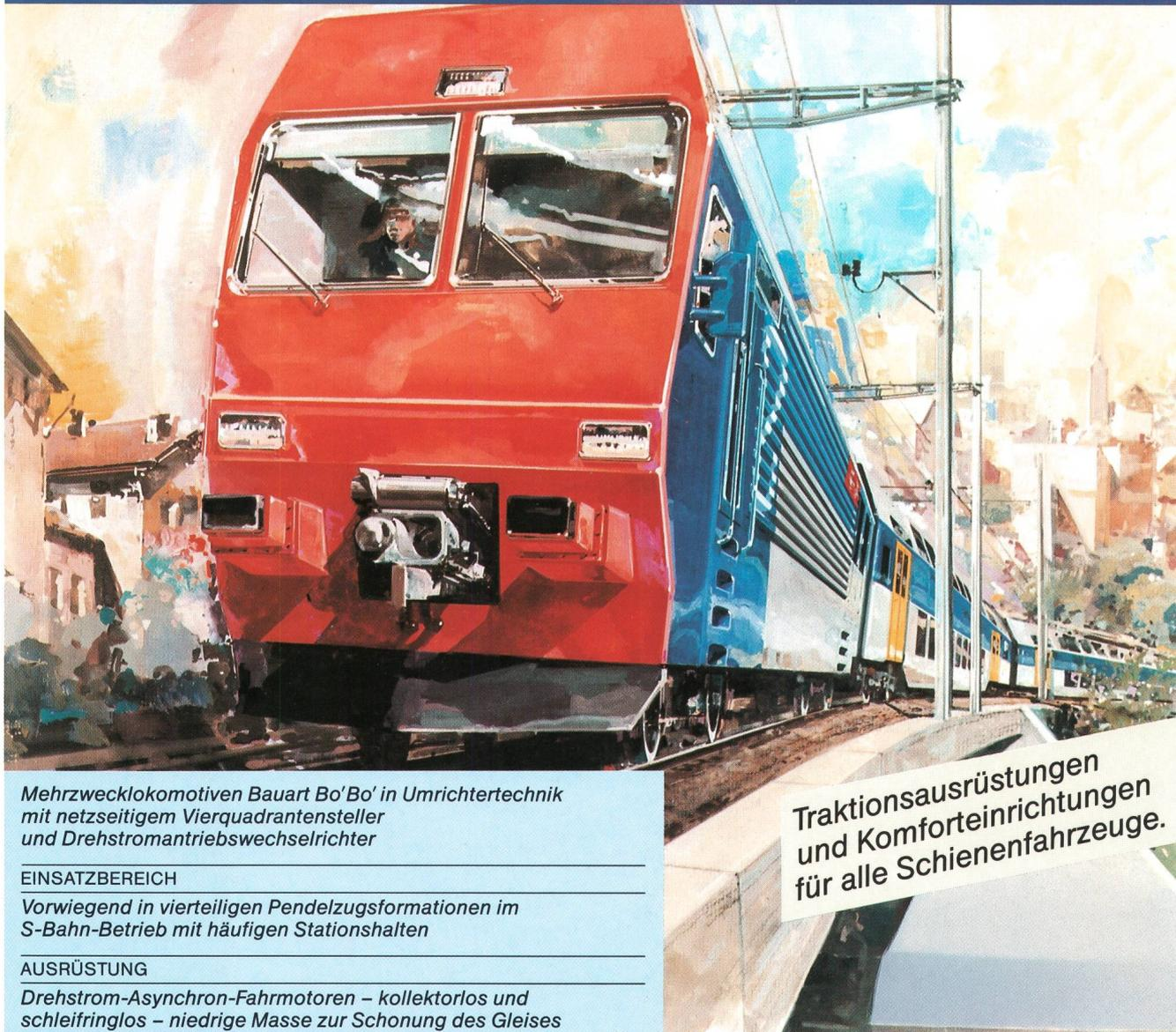
*Mehrzwecklokomotiven Bauart Bo'Bo' in Umrichtertechnik mit netzseitigem Vierquadrantensteller und Drehstromantriebswechselrichter*
