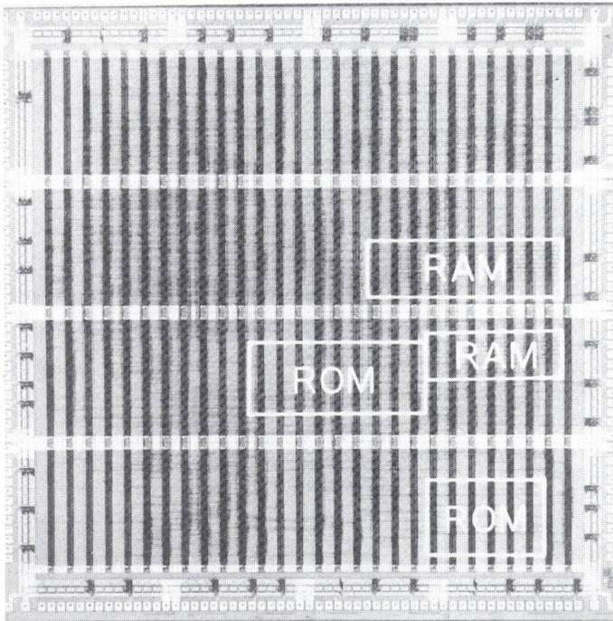
Figur 4 Gate-Array Chip
