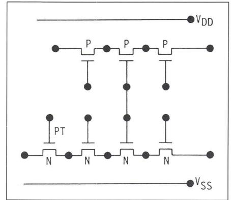
Figur 5 Transistorschema eines Sea-of-Gate Masters
