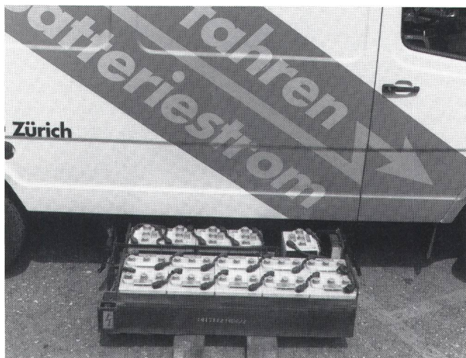
Figur 7 Antriebsbatterie (eine Hälfte) für Mercedes-Transporter 307 E, gesamt 180 V, Energieinhalt 34,2 kWh (5 h)
